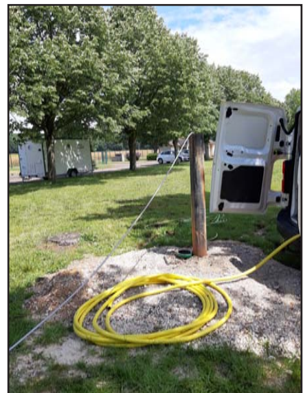
Photographie 6 : Injection du traceur, suivi de la chasse
