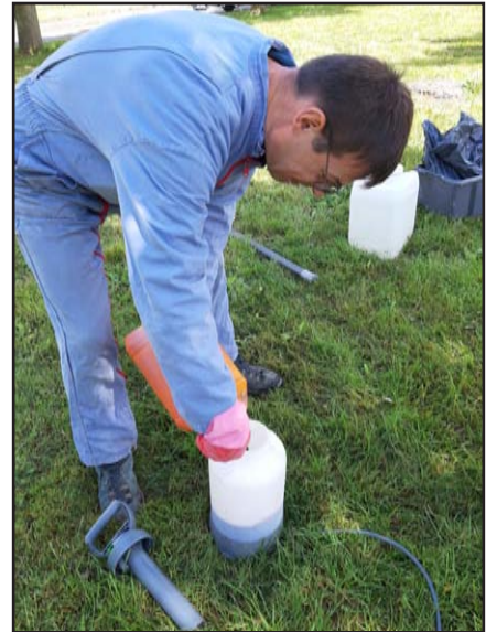
Photographie 4 : Dispositif d'injection du traceur
